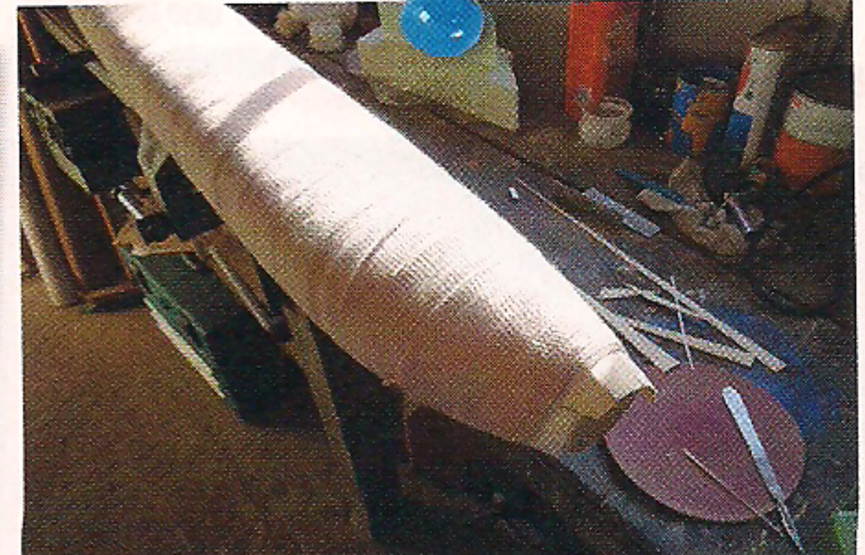
8 - Et voici le nez mis en forme. Il faut maintenant laisser sécher complètement le bois avant de «démouler».
