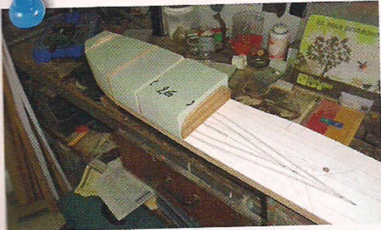
1 - Sur une planche découpée selon le contour du fuselage, des couples vont permettre la mise en forme des blocs de polystyrène extrudé en accord avec le plan.
