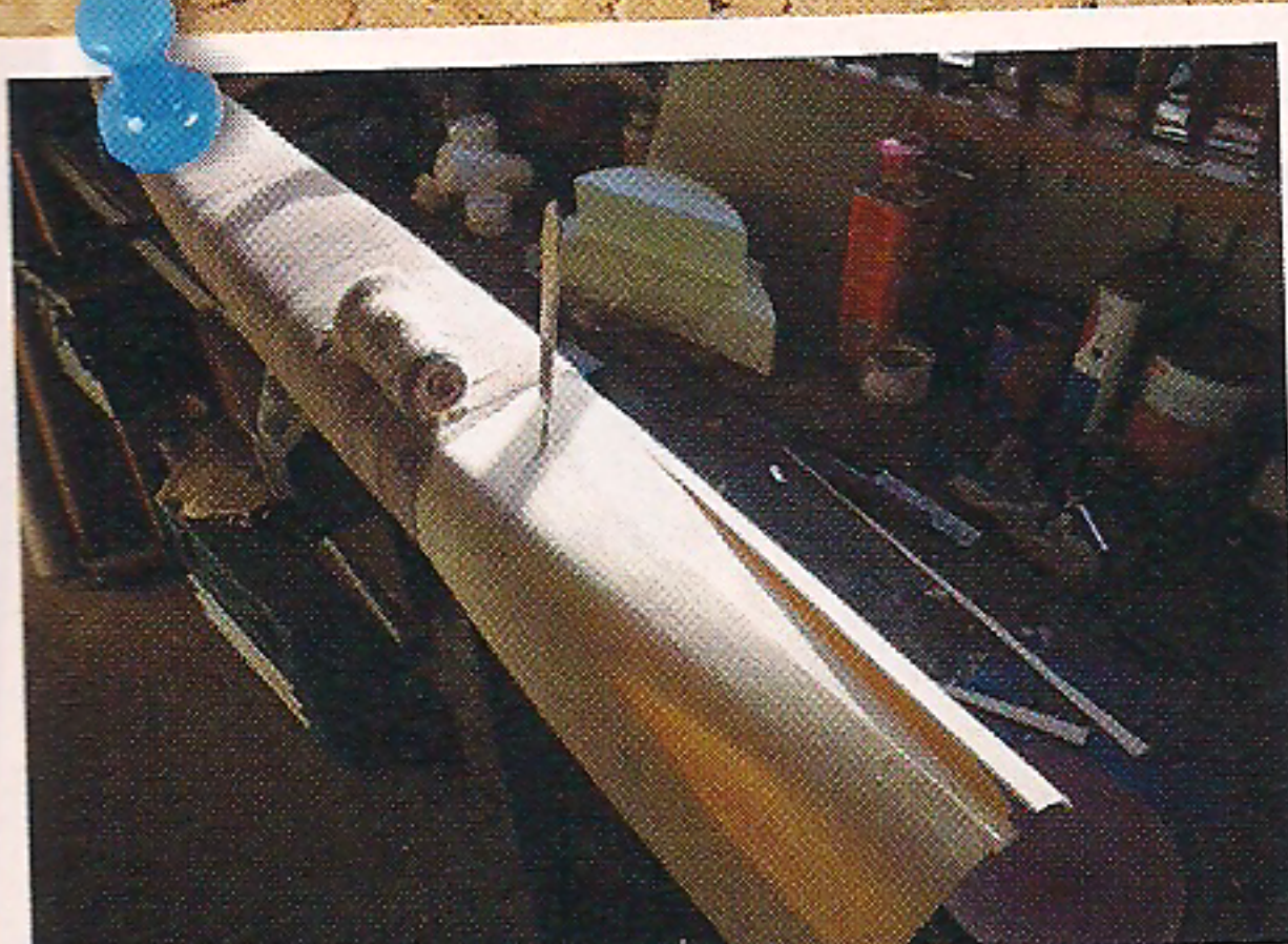
4 - Quand les formes ne sont pas développables, comme ici pour le nez, il est nécessaire de réaliser des incisions avant de serrer le bois.
