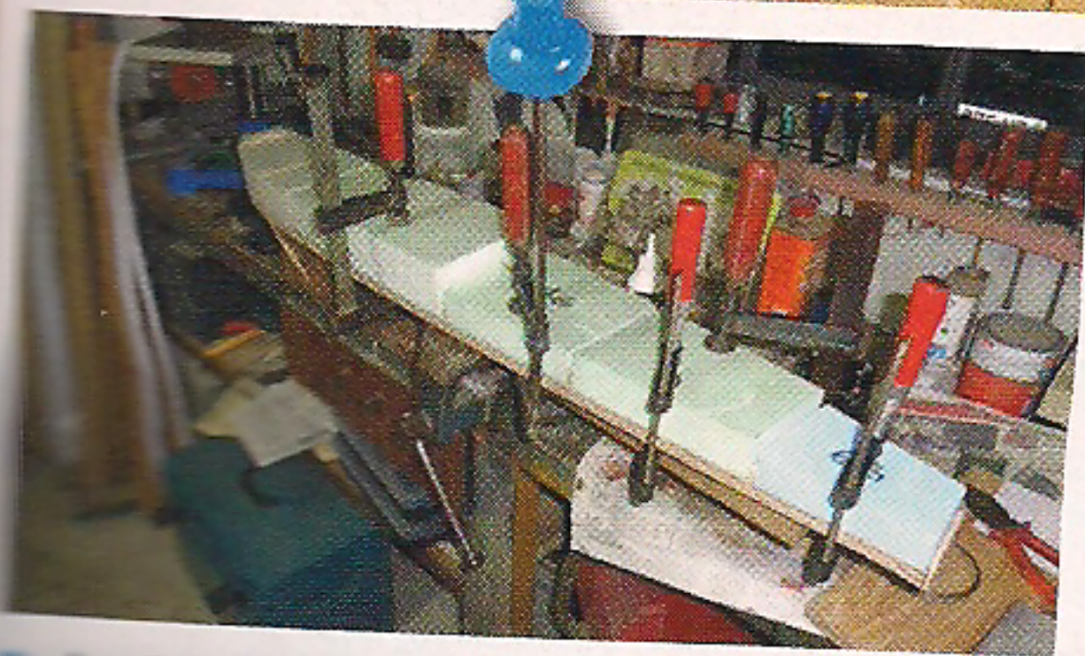
2 - Les blocs de polystyrène extrudés sont maintenus serrés durant le séchage de la colle.
