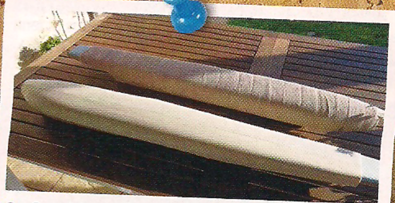
9 - On voit ici une demi-coque démoulée après séchage, tandis que l'autre demi-coque est toujours «enrubannée».
